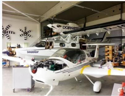
Das Bild entstand im Sommer bei MT-Propeller in Straubing. Zu diesem Zeitpunkt wurde die Cowling an den neuen Motor angepasst sowie die gesamte elektrische Installation ausgeführt.
